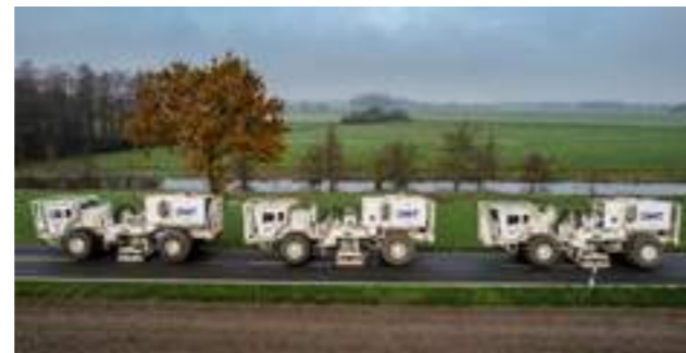
Vibrotrucks der DMT GROUP bei der Standorterkundung
